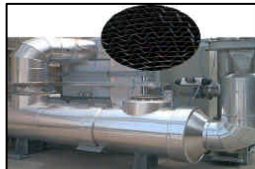
Figura 8. Instalación de oxidación catalítica con catalizador metálico.
